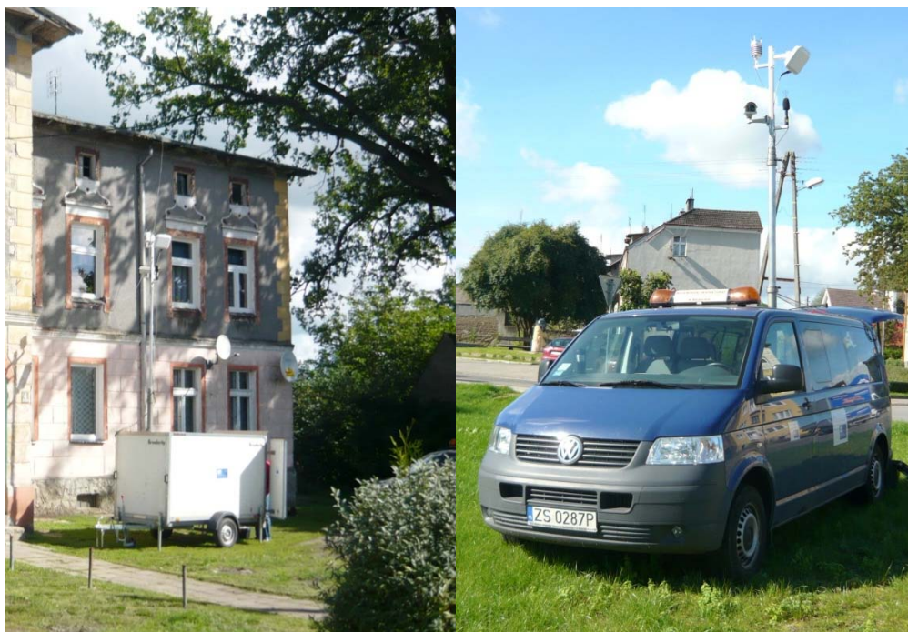
Fotografia IV.1 Automatyczne stacje monitorowania hałasu (fot.: WIOŚ w Szczecinie)
